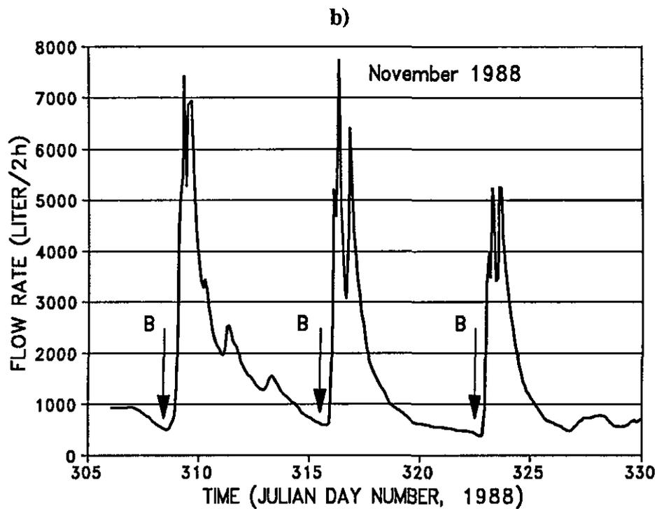
**Figuur 5.3** Die dreinerings tempo as 'n funksie van tyd in 'n mikrobesproeide wingerd op 'n skalieryke grond: a) September - Desember 1988; b) November 1988. Die aanvang van elke besproeiing gedurende November word met B aangedui.
