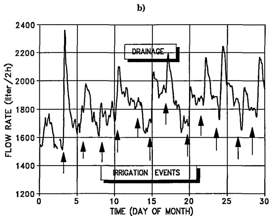
**Figuur 5.2** Die dreinerings tempo as 'n funksie van tyd in 'n drupbesproeide wingerd op 'n fynsandleem grond: a) September - Desember 1988; b) November 1988. Die aanvang van elke besproeiing gedurende November word met B aangedui
