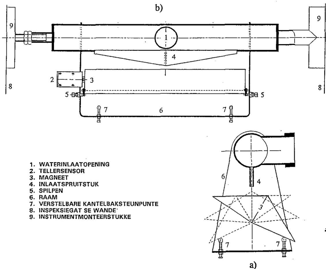
**Figuur 5.1** Skematiese voorstelling van die kantelbakvloei-meter van vlek-vrye staal: (a) dwarsnit en (b) vooraansig
