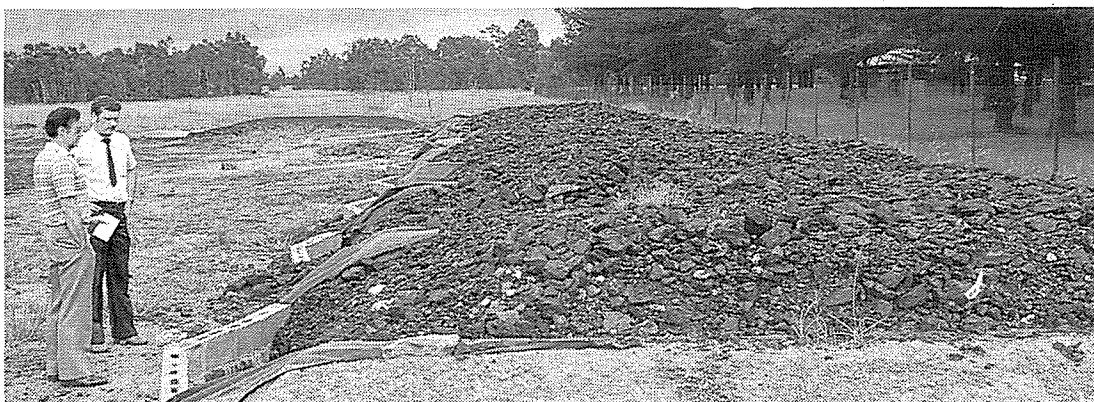
By die Wolvekrans – steenkoolmyn word tien toetssteenkoolhope in 'n veldeksperiment gebruik in verband met die navorsing oor die inhibering van bakteriese oksidasie van piriet en die meegaande suurmynwater.
