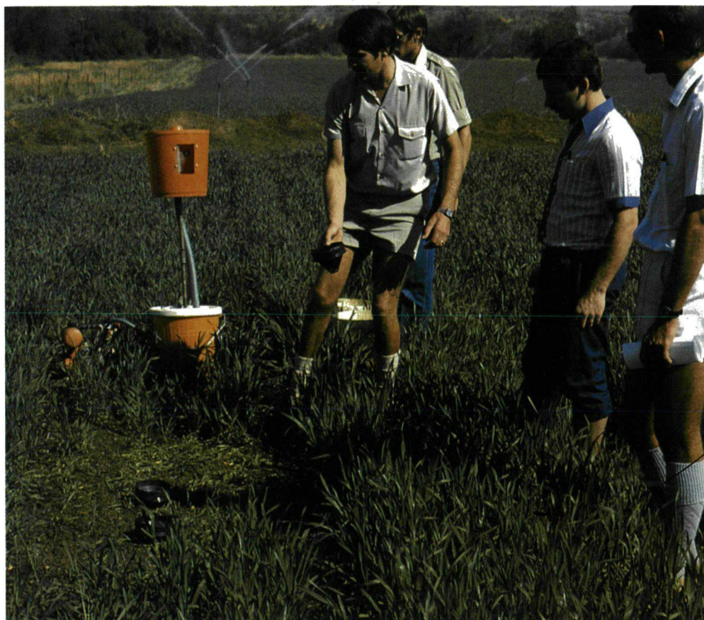
Links: 'n Infiltrasiemeter meet die grond se infiltrasievermoë en die spilpuntontwerp word daarby aangepas
