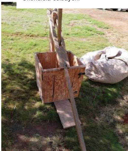
Ukwenziwa kwe-baler lezandla, ne-bale lengca yasemadlelweni
