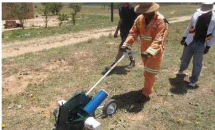
Ukusebenzisa iHaraka –isondo. Lomshini ukwazi ukutshala izimbewu ezahlukenene, kodwa awukwazi ukufaka nomanyolo ngesikhathi esisodwa
