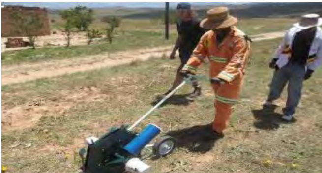
Ukusetyenziswa kweplantara enevili i-Haraka – Le plantara ikwazi ukutyala iintlobo-ntlobo zeembewu, kodwa ayivumelani nokufakwa kwezichumisi ngaxeshanye.
