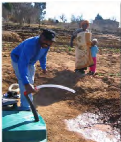
Impompo yokumfifitha amanzi eyenzelwe ekhaya engasetyenziswa ukufumana amanzi kumatanki akhelwe ngaphantsi komhlaba.
