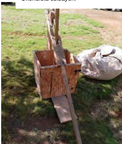
Ukwenziwa kwe-baler lezandla, ne-bale lengca yasemadlelweni
