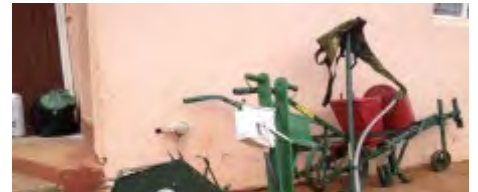
Izinhlobonhlobo zimishini yokutshala, MBLi(ozenza sageja) Haraka (isondo), Matracca(uyaphonsa) kanye nemishini edonswa izinkabi (knapik) ngezansi
