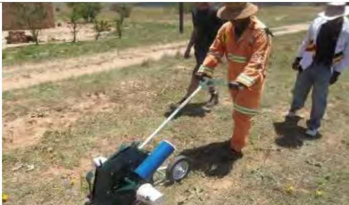
Ukusebenzisa iHaraka –isondo. Lomshini ukwazi ukutshala izimbewu ezahlukene, kodwa awukwazi ukufaka nomanyolo ngesikhathi esisodwa.
